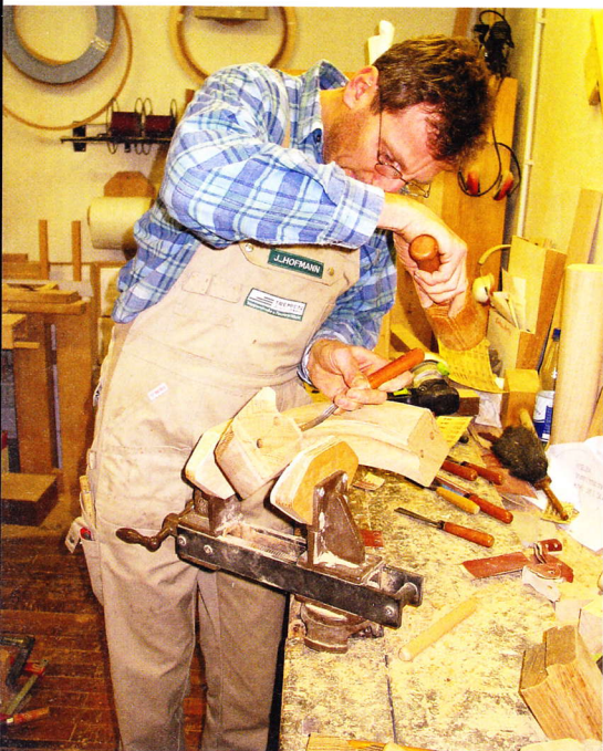
Ein Treppenkrümmling entsteht in der Werkstatt: Die Tischlerei schreckt auch vor aufwändigen Handläufen nicht zurück
